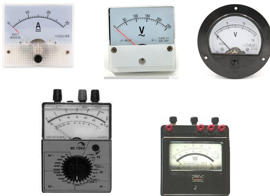
Slika 1.1. Izgled nekih analognih mernih instrumenata (ampermetar, voltmetar u četvrtastom i voltmetar u okruglom kućištu, univerzalni merni instrument – unimer, vatmetar)
