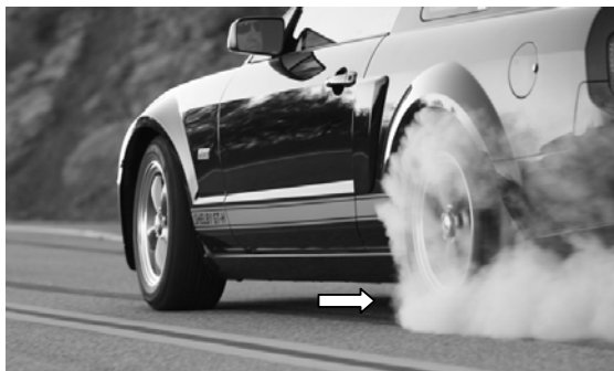
Slika 3-1. Proklizavanje između dve frikционе površine
