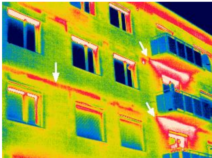
Слика 16-2-9: Пример топлотних мостова
