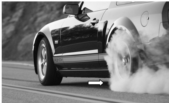
Slika 3-1. Proklizavanje između dve frikционе površine
