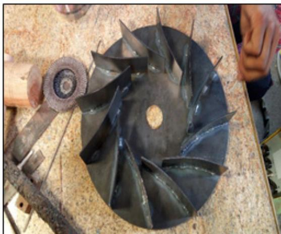
Figure 9. Impeller
